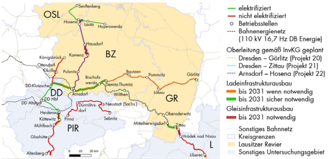
Abbildung 21: Infrastrukturbedarf für BEMU-Fahrzeuge (eigene Darstellung TU Dresden/VVO)
