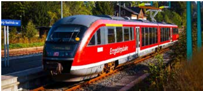
Abbildung 18: DB Erzgebirgsbahn EcoTrain mit Oberleitungs-Nachladung (Fotomontage F. Angermann)
